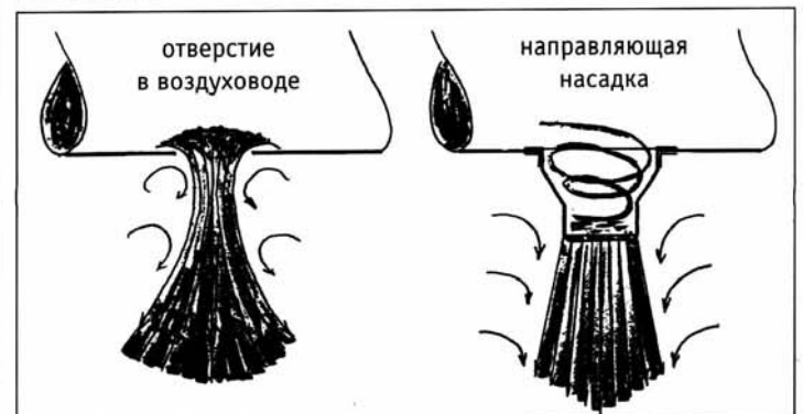
РИС.24 Различия между воздушным потоком, выходящим прямо из отверстий и из направляющих форсунок
